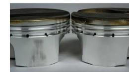
オイル上がりは、ピストンとシリンダーウォールに摩耗が発生することで発生します。この金属面の摩耗傷を安全に補修するために、リスロンはオイルの粘度からこだわり抜いた配合を行っています。
