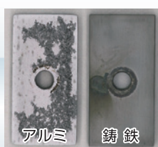
(図①) 劣化したクーラントの試験結果
