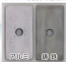
(図②) 劣化したクーラントにクーラントリカバリー添加後の試験結果
