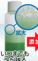
(図①) 劣化したクーラントの消泡性能
