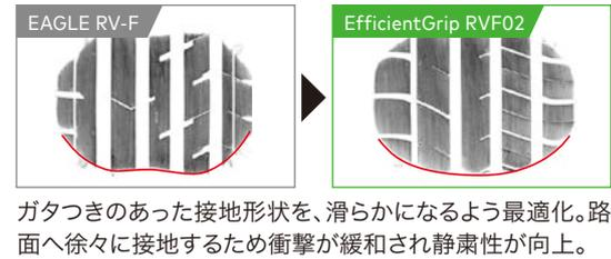
ガタつきのあった接地形状を、滑らかになるよう最適化。路面へ徐々に接地するため衝撃が緩和され静粛性が向上。
