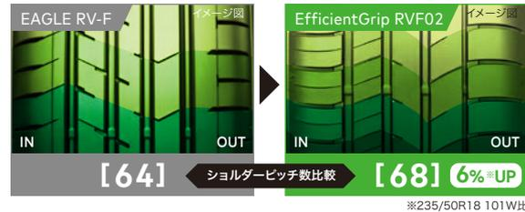
大きさが異なる5つのショルダーブロックの配列を最適化。ピッチ数を増やし、ランダムに配置することで路面からのピッチ音(叩き音)を分散。パターンノイズとピッチノイズの低減に貢献します。
